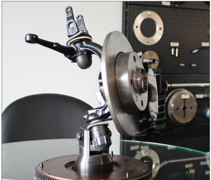
Achsschenkel eines Trabis mit Radaufhängung: In das Bauteil eingepresst sind Schwenklagerbuchsen aus iglidur J Hochleistungskunststoff (beige).
