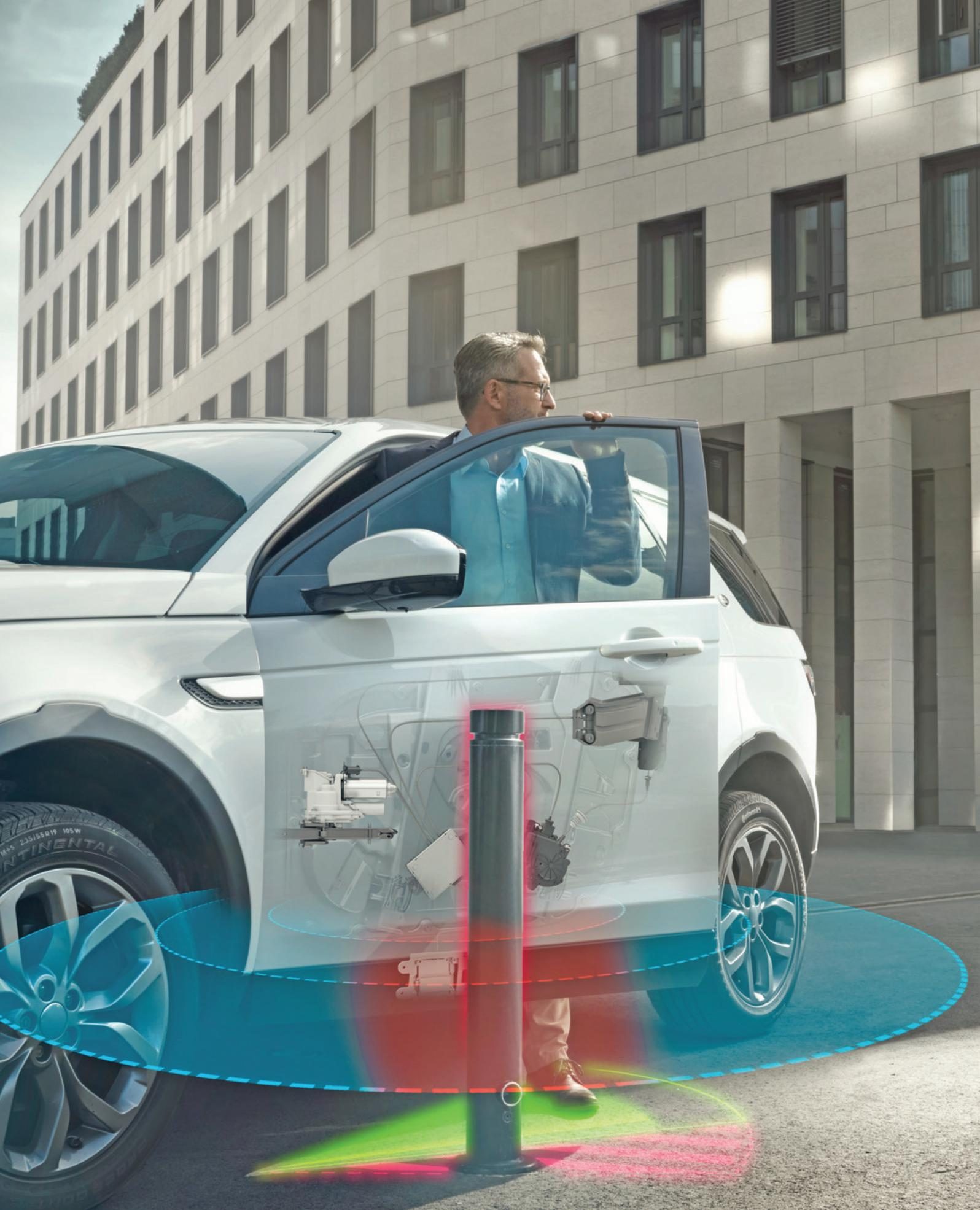
Das Brose System für angetriebene Seitentüren macht auch den manuellen Betrieb komfortabler und sicherer. Eine integrierte Radarsensork erkennt Hindernisse und stoppt die Türbewegung vor einer Kollision.
