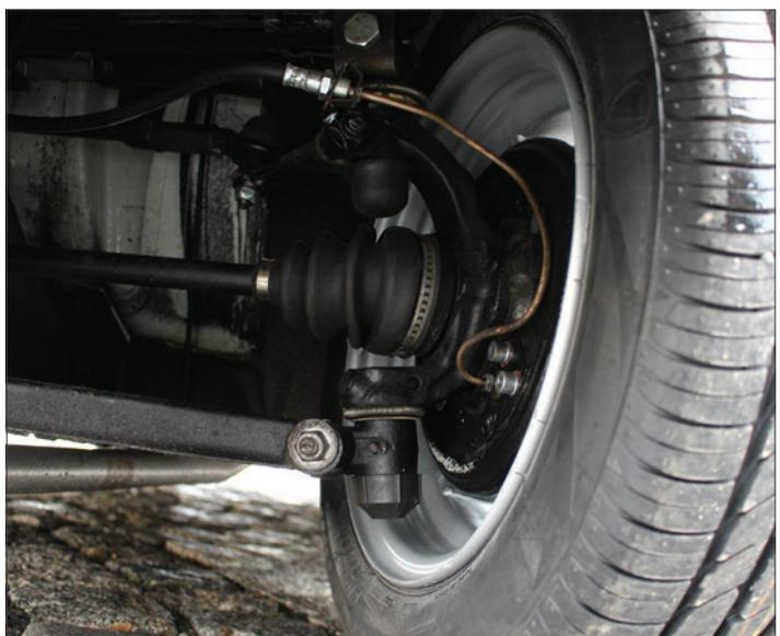
Blick unter den Trabi: Die Spurstangen schwenken den Achsschenkel. In die Achsschenkel eingepresst sind die verschleißfesten und wartungsfreien iglidur J Gleitlager.
