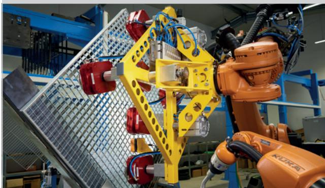
Magnetgreifer für (perforiertes) Blech-Handling oder Stahlgitter in automatisierten Produktionslinien, Robotern und Pick & Place Systemen. Keine Umrüstung für unterschiedliche Produkte notwendig. Nachhaltig durch geringeren Energieverbrauch.
