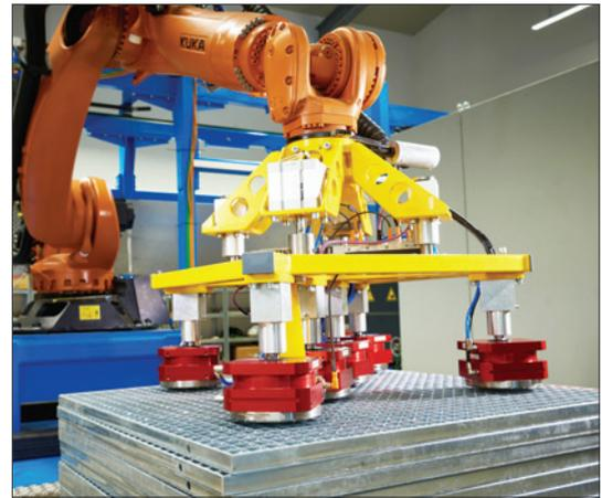
positioniert werden, denn wenn sich diese teilweise auf einem Loch befinden, funktionieren sie nicht. Die von den Herstellern eingesetzten Elektromagnete bieten ebenfalls keine Lösung für dieses Problem, da sie ein zu kleines Magnetfeld besitzen und daher weniger Blechmaterial angehoben werden kann. Ein Magnetgreifer mit Permanentmagneten ist erheblich leichter. Außerdem ist der Greifer verschleißfest und verfügt über eine längere Lebensdauer als Vakuumgreifer.
